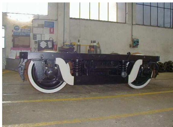
Bau neuer Drehgestelle für den Orient Express
